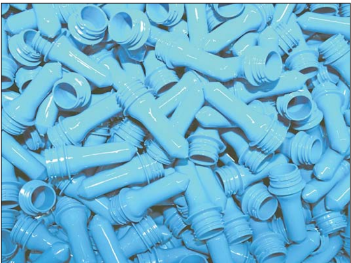
Lothar Terno (links, großes Foto) lässt sich von Carsten Brakhage (Leiter Qualitätswesen bei Hansa-Heemann) die PET-Flaschenherstellung erläutern. Eine Maschine kann 32 000 Flaschen je Stunde füllen, auf Bändern (oben rechts) gelangen sie zur nächsten Station. Die Flaschenrohlinge werden Pre-Forms genannt (unten rechts). Fotos: Harald Fichtner
